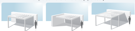
Exemple de fixations murales (2 poteaux)
